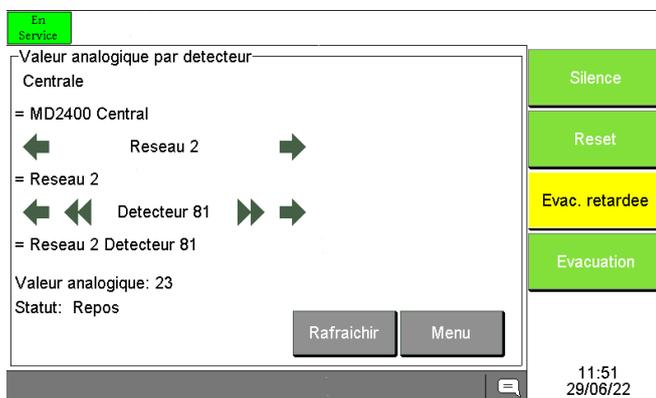
Si l'option « **Par detecteur** » est sélectionnée, il faudra ensuite sélectionner le réseau (Circuit en boucle n° 1 ou 2) voulu ainsi que le détecteur souhaité à l'aide des flèches (←, →, ((, )))
