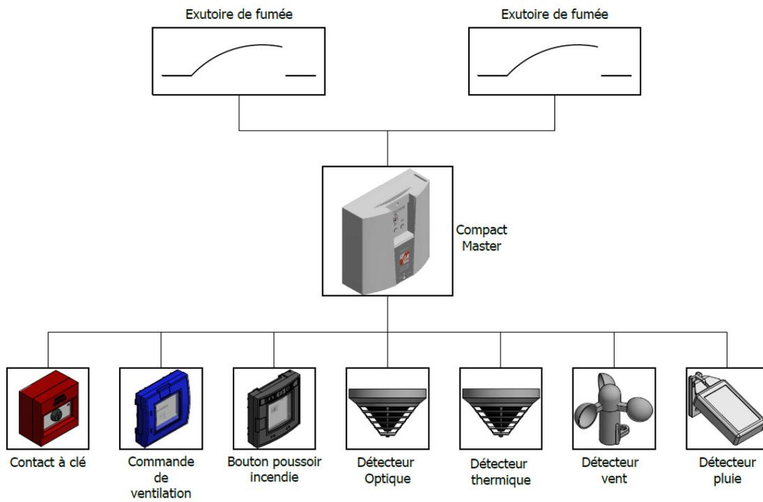
F) Schema de principe avec plusieurs Compact.EFS
