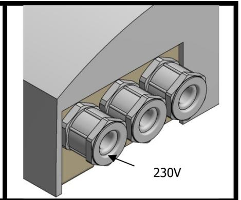
Pour le 230V : utilisez l'émerillon au-dessus à gauche et assurez une décharge en traction suffisante. Pour des plus fins câbles, par ex: pour boutons poussoirs, un émerillon adapté doit être sélectionné.
