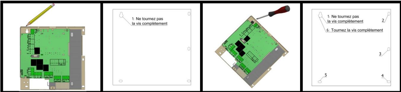
Utilisez la centrale comme modèle pour dessiner les trous. La centrale ne peut pas être utilisée comme modèle de forage !
