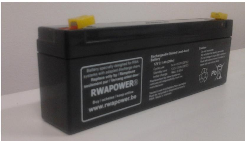
**Les batteries doivent préventivement être remplacées tous les trois ans.** Lors de l'entretien annuel, les batteries doivent être testées avec un testeur de batterie. (Il faut contrôler si la tension des batteries ne baisse pas en charge)
