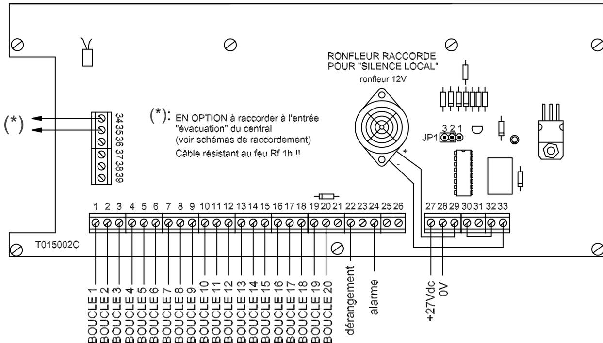
Câblage: - 2 x 0.75mm<sup>2</sup> pour l'alimentation (+ et - 27V)
